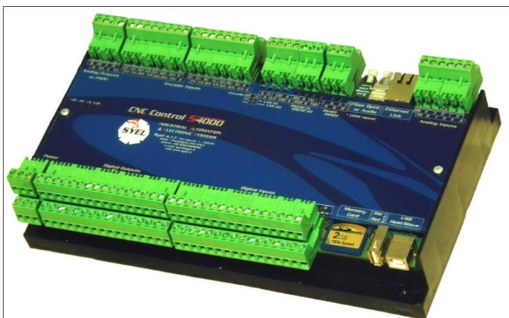
La gamma è completata da una serie di apparecchiature "cieche" che hanno tutte le caratteristiche delle apparecchiature con monitor, e che possono essere utilizzate come nodi intelligenti senza display, oppure con display remotato, oppure come espansioni di apparecchiature con display o come periferiche di un PC. Possono far parte di una rete Ethernet, Can, Rs-232, Rs 485.
